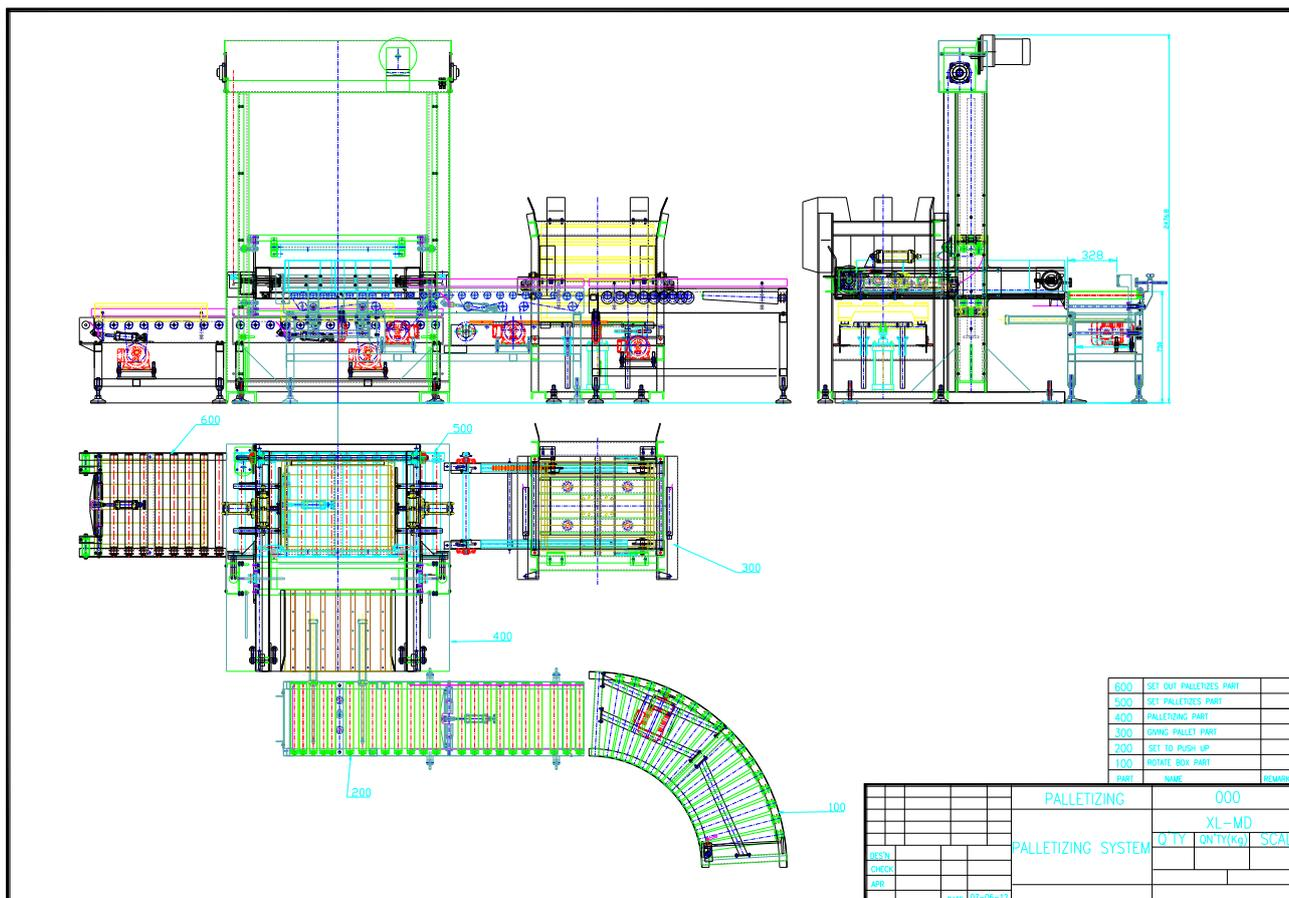
码垛机是将已装入容器的纸箱，将一定排列码放在托盘（木质）上，进行自动堆码，可堆码多层，然后推出，便于叉车运至仓库储存。本设备采用 PLC+触摸屏控制，实现智能化操作管理，简便、易掌握。可大大地减少劳动人员和降低劳动强度。
