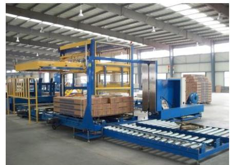
力诺太阳能开箱装箱封箱捆扎码垛流水线
