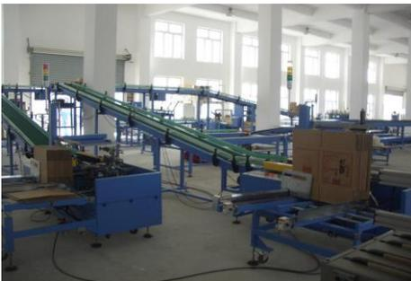
太太乐食品开箱装箱封箱捆扎码垛流水线
