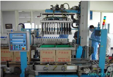
白猫洗洁精开箱装箱封箱码垛捆扎流水线
